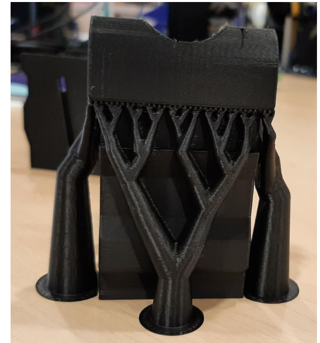
Abb. 18: Stützen ohne Rand (Mediothek Diepholz)
