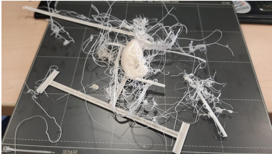
Abb. 19: Filament Unfall (Mediothek Diepholz)
